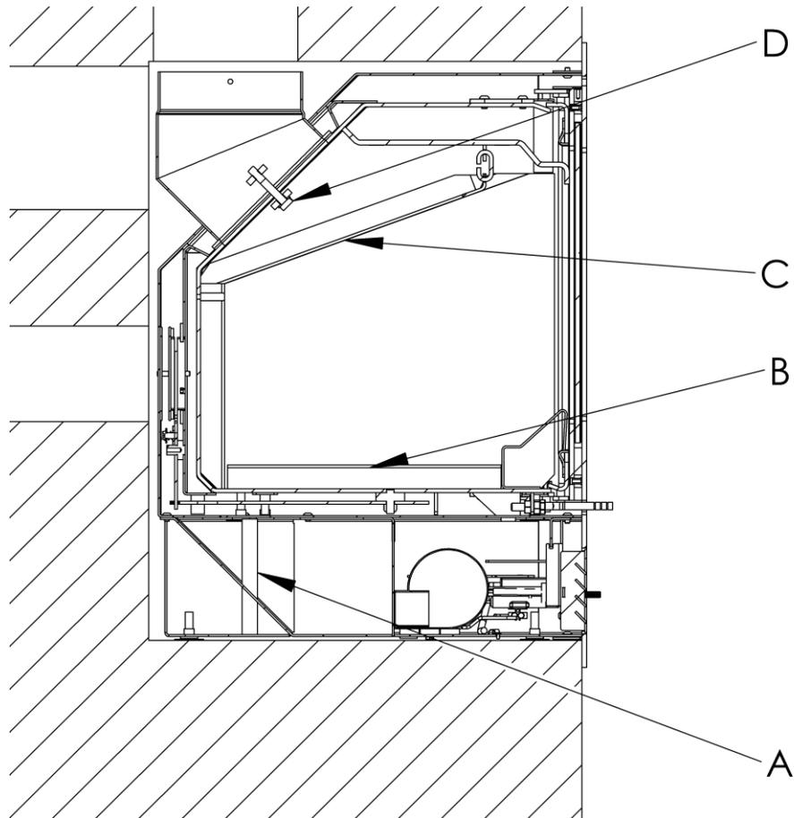
Es gibt unzähligen Möglichkeiten die Kassetten einzubauen. Die können in der Wand und auf der Wand gebaut werden, und sie können an der Wand hängen. Bloss darf Einbauen nur in Verbindung mit unbrennbarem Material stattfinden. Fast alle Installationen werden individuell entworfen und in allem Fallen soll der Abstand zum Brennbares in Übereinstimmung mit den Vorschriften sein.
