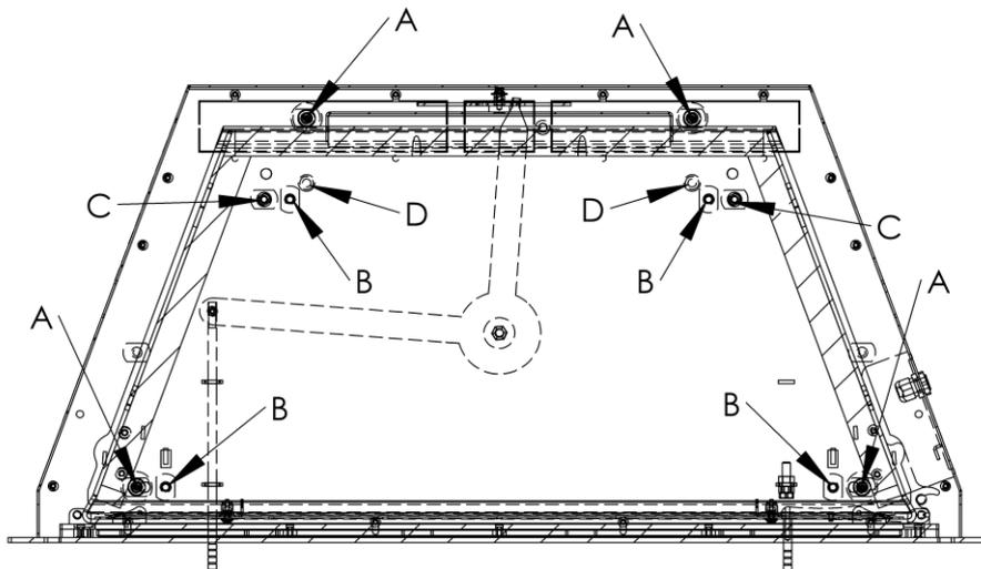
A Die Stellschrauben des Gehäuses justieren die ganze Einbaukassette im Verhältnis zur Unterlage.
