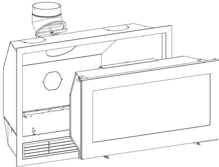
Die Kassette ist aus den Haken bei den vorderen Füßen auszurasen und aus dem Gehäuse herauszunehmen. Das Knierohr ist an den Schornstein anzuschliessen.
