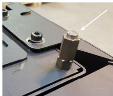
Toppplattan justeras med de fyra skruvorna under topplattan.
