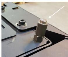
Die Topplatte wird passend mit den 4 Muttern unter der Topplatte, in der Höhe justiert.
