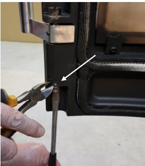
Enlevez la goupille et serrez la vis (dans le contre-sens d'une aiguille d'une montre) jusqu'à l'obtention de la résistance convenable.
