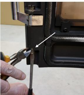
Den Stift entfernen und Den Zapfen anziehen (gegen Uhrzeigersinn) je nach Wunsch, wie kräftig die Federkraft im Griff sein soll.
