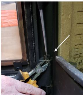
Den Stift entfernen und die Schraube anziehen (Uhrzeigersinn) je nach dem wie schnell die Tür zugehen soll.
